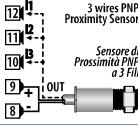
Esempio di collegamento di un sensore di prossimità a 3 fili.
