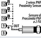
Esempio di collegamento di un sensore di prossimità a 2 fili.
